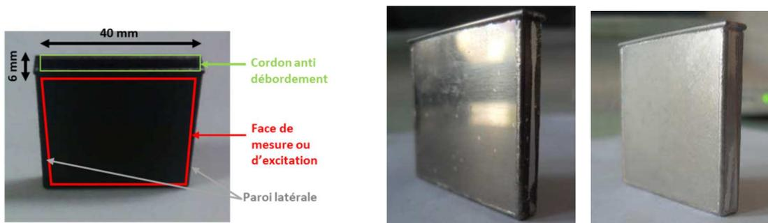
Figure 29 : Descriptif de la cellule de mesure en Pt/Rh avec et sans son revêtement absorbant
