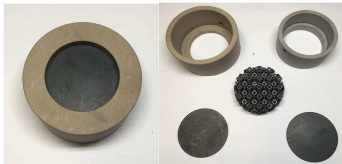
Figure 53 : Système porte échantillon des mousses céramiques
