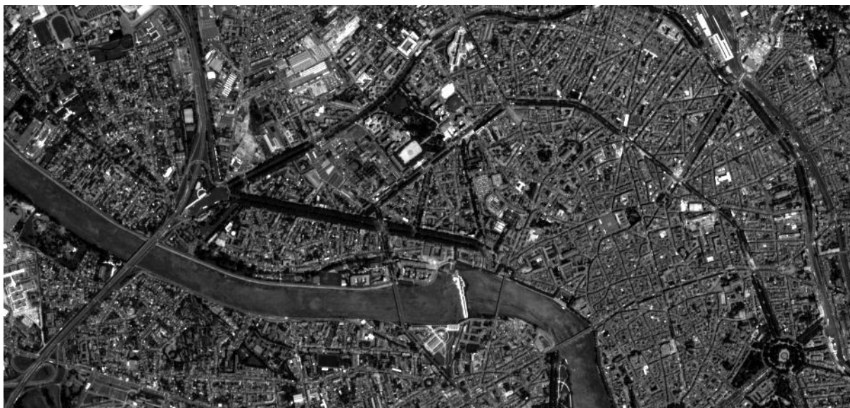
FIG. 1.2 – Image de Toulouse de taille 945 \times 450 pixels acquise par le mode panchromatique de SPOT 5 à la résolution de 5 m par pixel.
