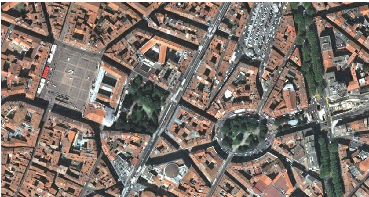
FIG. 1.3 – Image couleurs simulée PLEIADES à la résolution de 70 cm par pixel de taille 945 \times 450 (image extraite de [9] – © CNES 2006).
