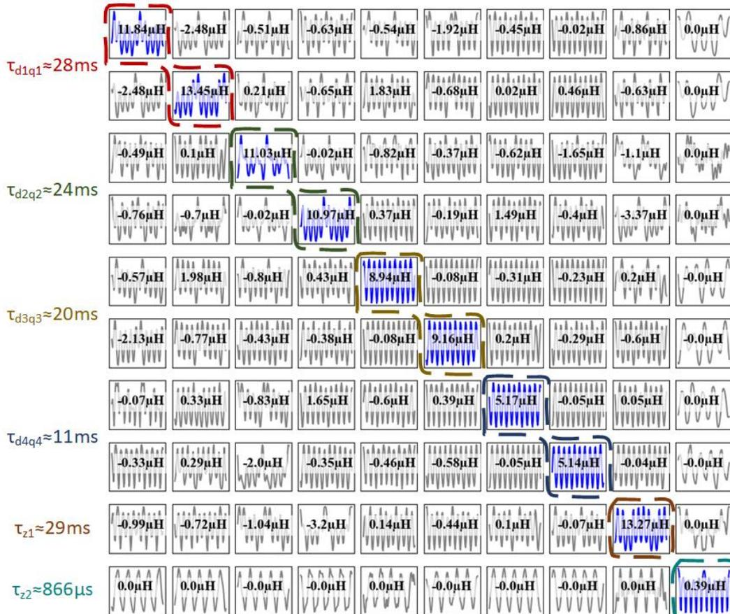
Figure Annexe D.7 : Matrice inductance dans la base de découplage  $d - q$  sur une période électrique, configuration 10ph obtenue à partir des matrices Clarke et Park généralisées 10x10
