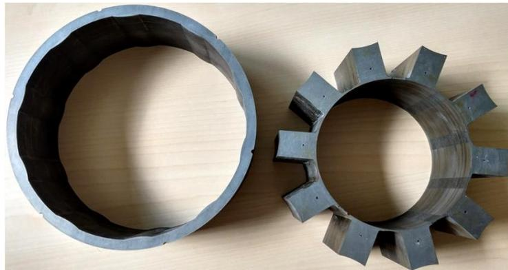
Figure 3.44 : Composition du stator en deux éléments principaux, une couronne extérieure (gauche) et une étoile intérieure (droite)
