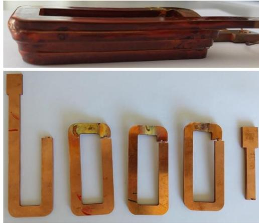
Figure 3.46 : Composition d'une bobine (haut) à partir de spires élémentaires (bas)
