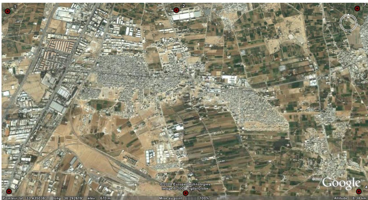
Figure 13 : Exemple de la répartition de points d'amer sur un cliché extrait de Google Earth dans l'espace étudié (le cas de la transformation polynomiale de deuxième degré).
