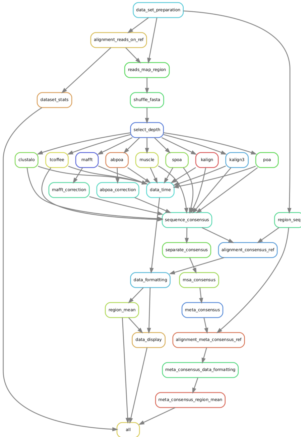
FIGURE 4.7 – Graphe des règles snakemake du pipeline MSA_Limit
