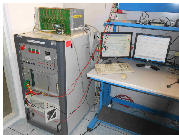
FIGURE 3.7 – Environnement Hardware In the Loop chez Alstom [63].
