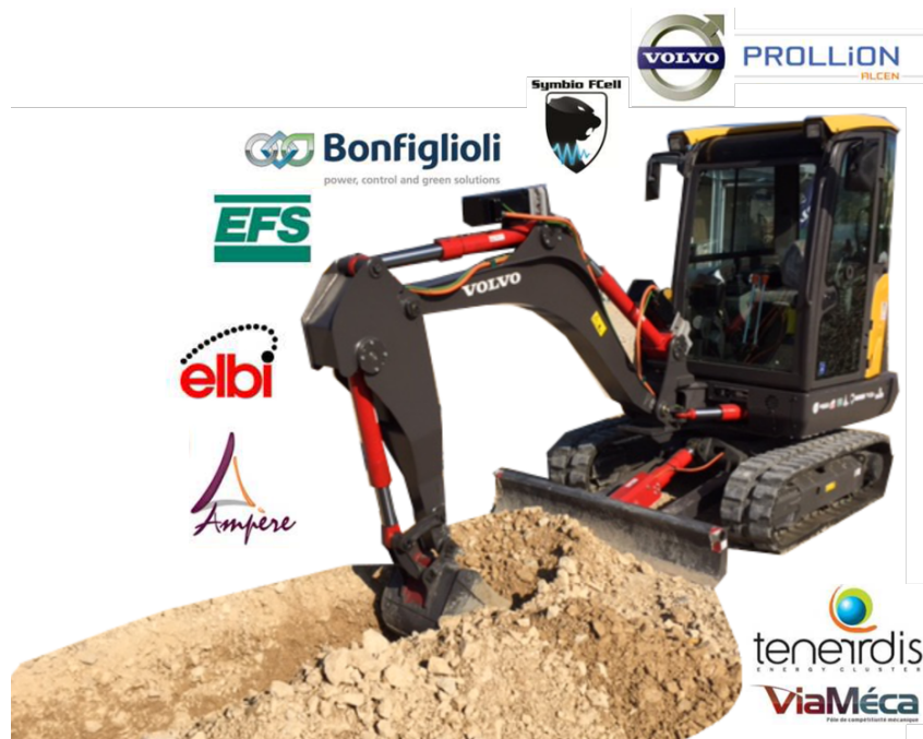
FIGURE 3.23 – Prototype de mini-pelle tout électrique issu du projet ELEXC [40].
