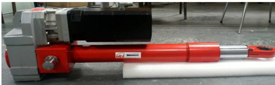
FIGURE 3.22 – Actionneur électromécanique (EMA) avec moteur synchrone à aimants permanents, réducteur et vis à rouleau afin d’obtenir un déplacement linéaire et remplacer un vérin hydraulique [40].
