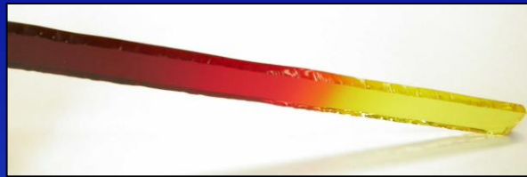
Effet de confinement quantique (verre \text{CdS}_{1-x}\text{Se}_x )
