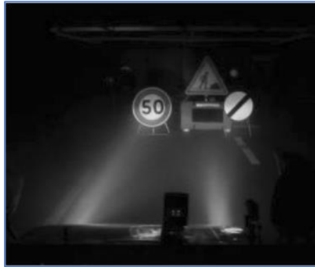
Figure 1-4 : Scène avec trois panneaux de signalisation et une surface chauffante.
