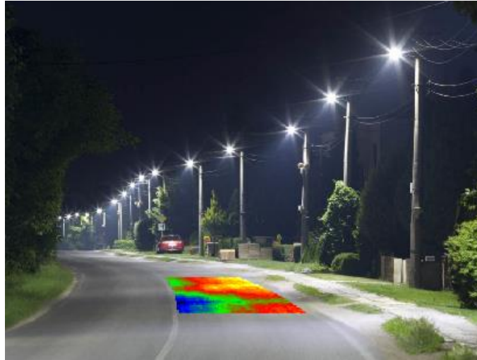
Figure 6-5 : Mesure de luminance de chaussée par ILMD
