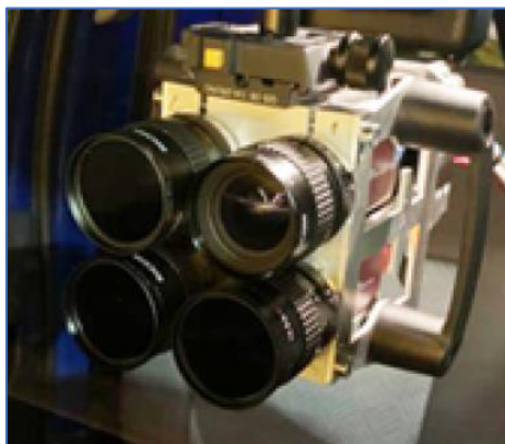
Figure 4-1 : Système HDR à 4 caméras
