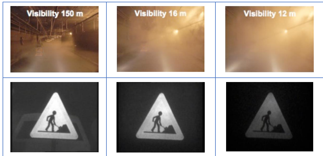
Figure 2-2 : Résultats obtenus par porte temporelle pour un panneau à 30 m dans le brouillard
