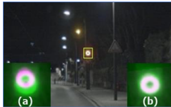
Figure 4-7 : Zones extraites dans IMG 1 (vert) et IMG 2 (rose) avant (a) et après recalage (b).
