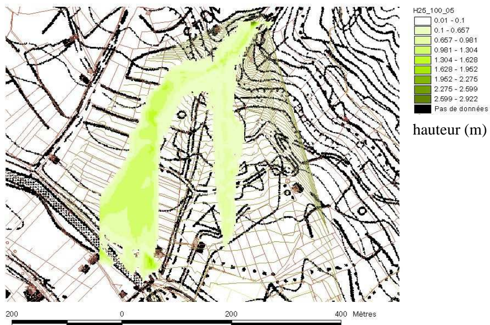
Figure 4.14 Hauteurs maximales simulées pour un volume de 25 000 m 3 , un débit de pointe de 100 m 3 /s et un rapport \tau_c/\rho = 0,5 \text{ m}^2/\text{s}^2 (NB : les limites du domaine de calcul étant atteintes, les extensions de la coulée à son extrémité inférieure gauche n'ont pu être simulées correctement)
