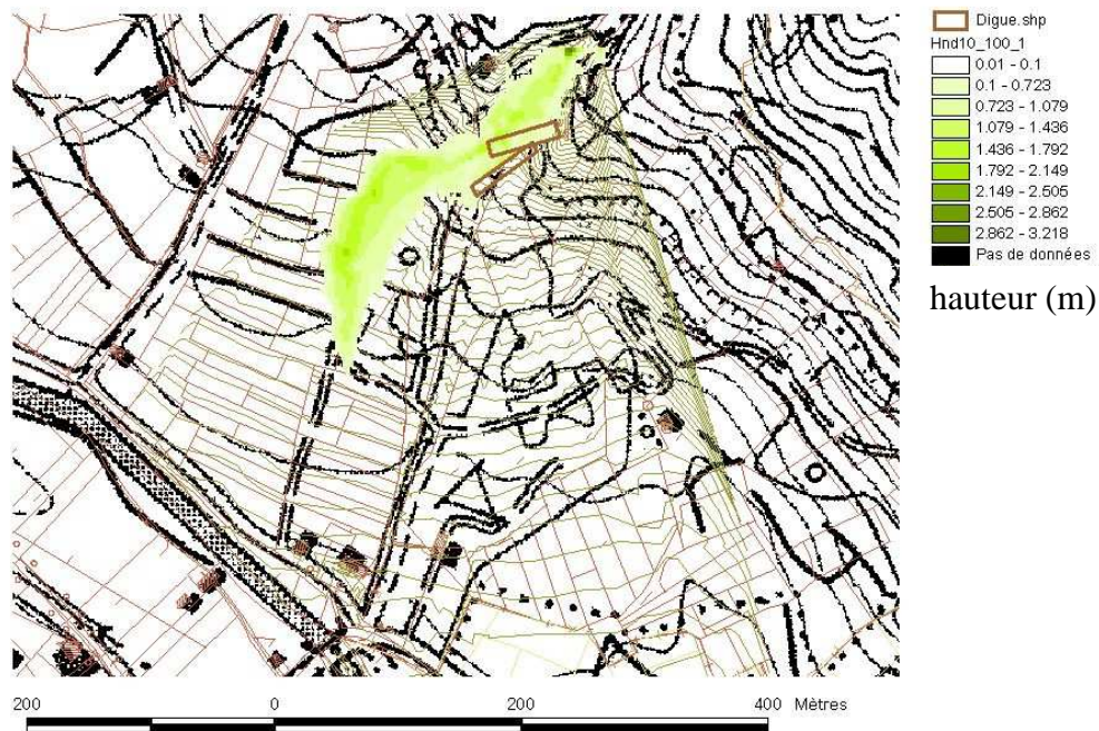
Figure 4.19 Hauteurs maximales simulées pour un volume de 10\,000\text{ m}^3 , un débit de pointe de 100\text{ m}^3/\text{s} et un rapport \tau_c/\rho = 1,0\text{ m}^2/\text{s}^2 dans l'hypothèse de l'implantation d'une digue présentant un angle d'incidence d'environ 15^\circ par rapport au chenal amont du torrent
