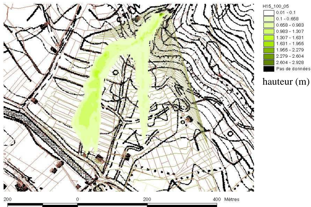
Figure 4.13 Hauteurs maximales simulées pour un volume de 15 000 m 3 , un débit de pointe de 100 m 3 /s et un rapport \tau_c/\rho = 0,5 \text{ m}^2/\text{s}^2
