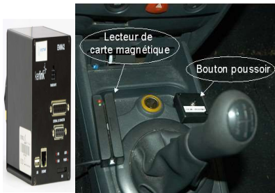
Illustration 2 : Enregistreur de données, lecteur de carte magnétique et bouton poussoir
