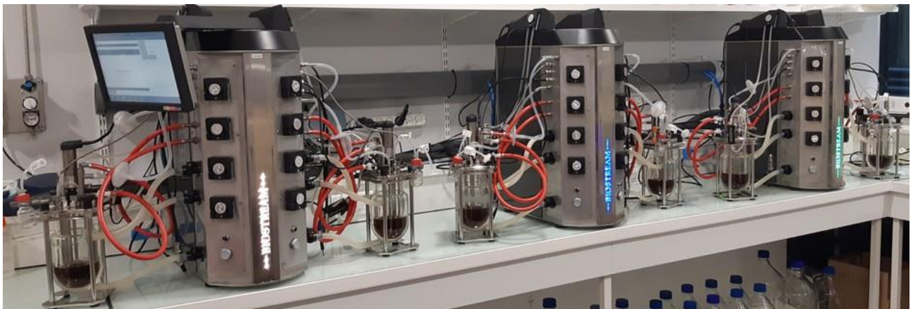
Figure 20: Système de 6 fermenteurs anaérobies de l'équipe FInE de MICALIS. Ces fermenteurs fonctionnent en parallèle, indépendamment les uns des autres, ce qui permet de tester 6 conditions différentes en même temps. Photo C. Maillat @INRAE MICALIS FInE
