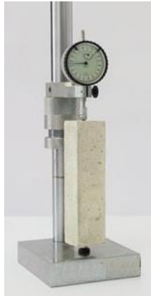
Figure 4.19 : Bâti de mesure des variations dimensionnelles.
