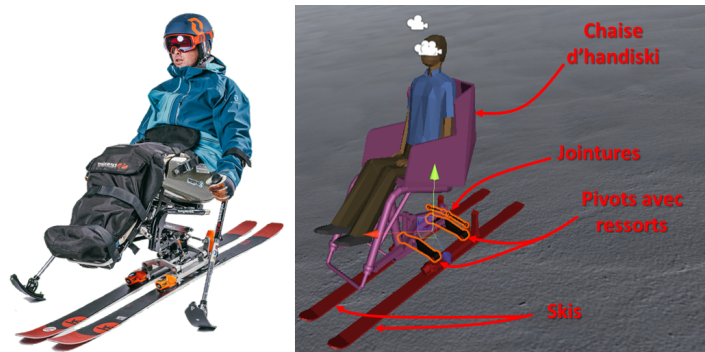
Figure 8.16 – Modélisation CAO d'un modèle double-ski d'handiski.
