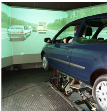
(a) Simulateur de conduite de Renault [Rey+00] (b) Simulateur de conduite Virtex de Ford [Gra+01]
