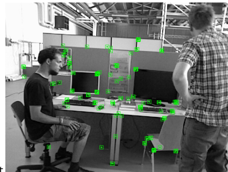
(a) Nombre moyen de points d'intérêt dynamiques rejetés par image via le DAM. (b) points d'intérêt statiques conservés avec le DAM.
