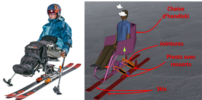
Figure 8.16 – Modélisation CAO d'un modèle double-ski d'handiski.
