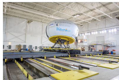
(b) Simulateur hybride NADSdyna [Che+01]
