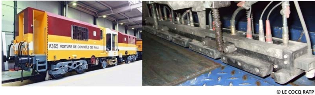
Figure 36 : Véhicule de mesure V365 de la RATP, dédié à la détection des défauts internes du rail, équipé de sondes ultrasons
