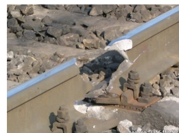
(c) Rupture en baïonnette en pleine barre
