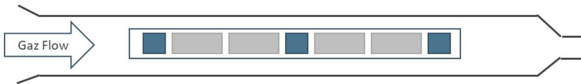
Figure 6-25: Disposition des échantillons de Si dans le réacteur : carrés bleu = témoins et rectangles gris = échantillons dédiés à l'analyse électrochimique
