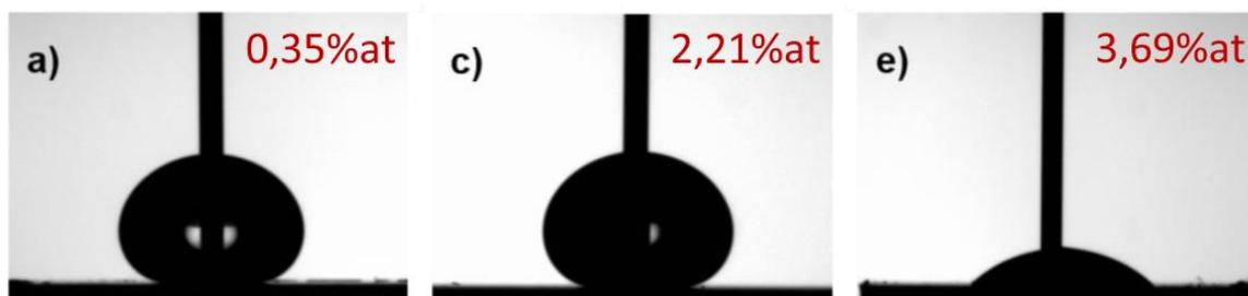
Figure 3-6: Evolution de la mouillabilité en fonction du pourcentage d'azote inséré dans les N@VACNT [205]
