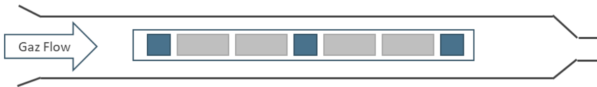
Figure 6-25: Disposition des échantillons de Si dans le réacteur : carrés bleu = témoins et rectangles gris = échantillons dédiés à l'analyse électrochimique
