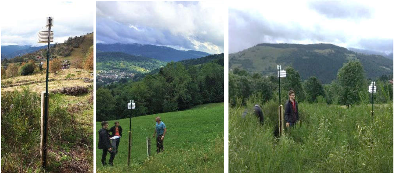
Figure 48 : Implantation de capteurs de températures sur différents sites vers La Bresse (Vosges)
