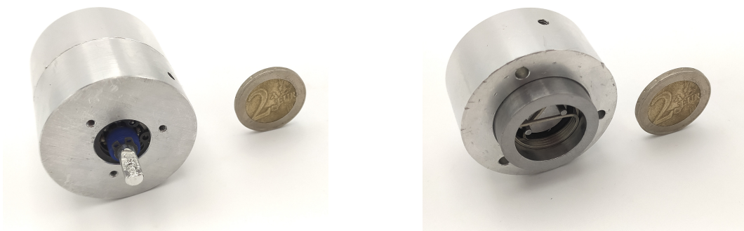
FIGURE 7.17 – Photo du prototype de NBDM, complètement monté à gauche, et partiellement monté à droite
