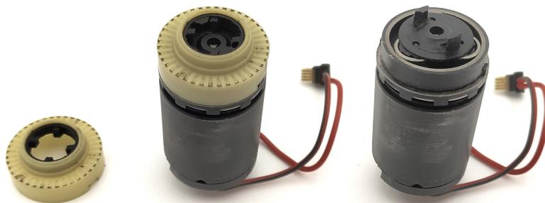
FIGURE 7.3 – Mécanisme d'irréversibilité utilisé par Ottobock dans la *VariPlus Speed*. À gauche le mécanisme est présenté seul, au milieu le mécanisme est monté sur le motoréducteur, à droite le motoréducteur est présenté seul. Le ressort enroulé est placé entre les couronnes noires et le châssis jaune, et n'est pas visible.
