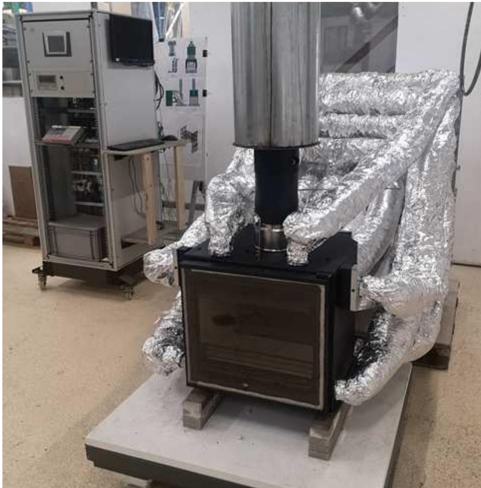
FIGURE 1.5 – Image du banc expérimental pour l'étude de la combustion du bois dans les poêles domestiques.
