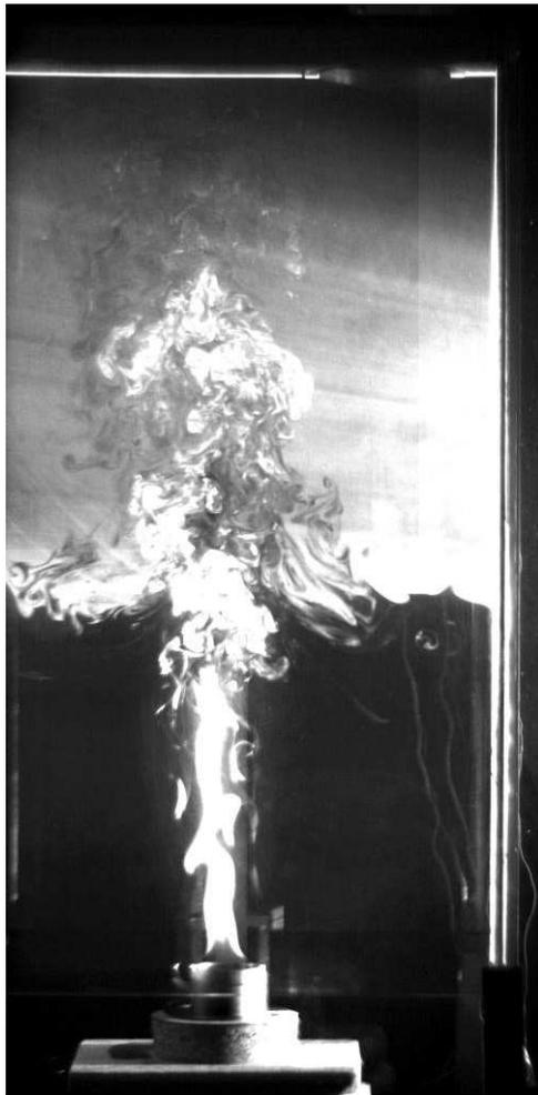
FIGURE 3.11 – Image issue d'expériences réalisées au LEMTA. Il s'agit d'un compartiment en polycarbonate, permettant visualiser l'écoulement et la flamme. Le compartiment dispose d'un exutoire au plafond pour permettre l'évacuation naturelle des fumées. On observe le processus de remplissage et de vidange et la formation d'une couche de fumées stable.
