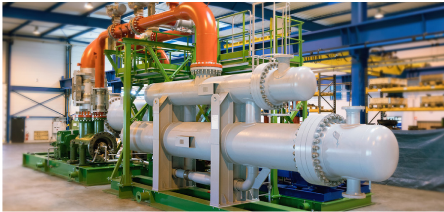
FIGURE 1.16 – Photo de la technologie ORC industrielle développée par l'entreprise française Enertime. (Source : Enertime)
