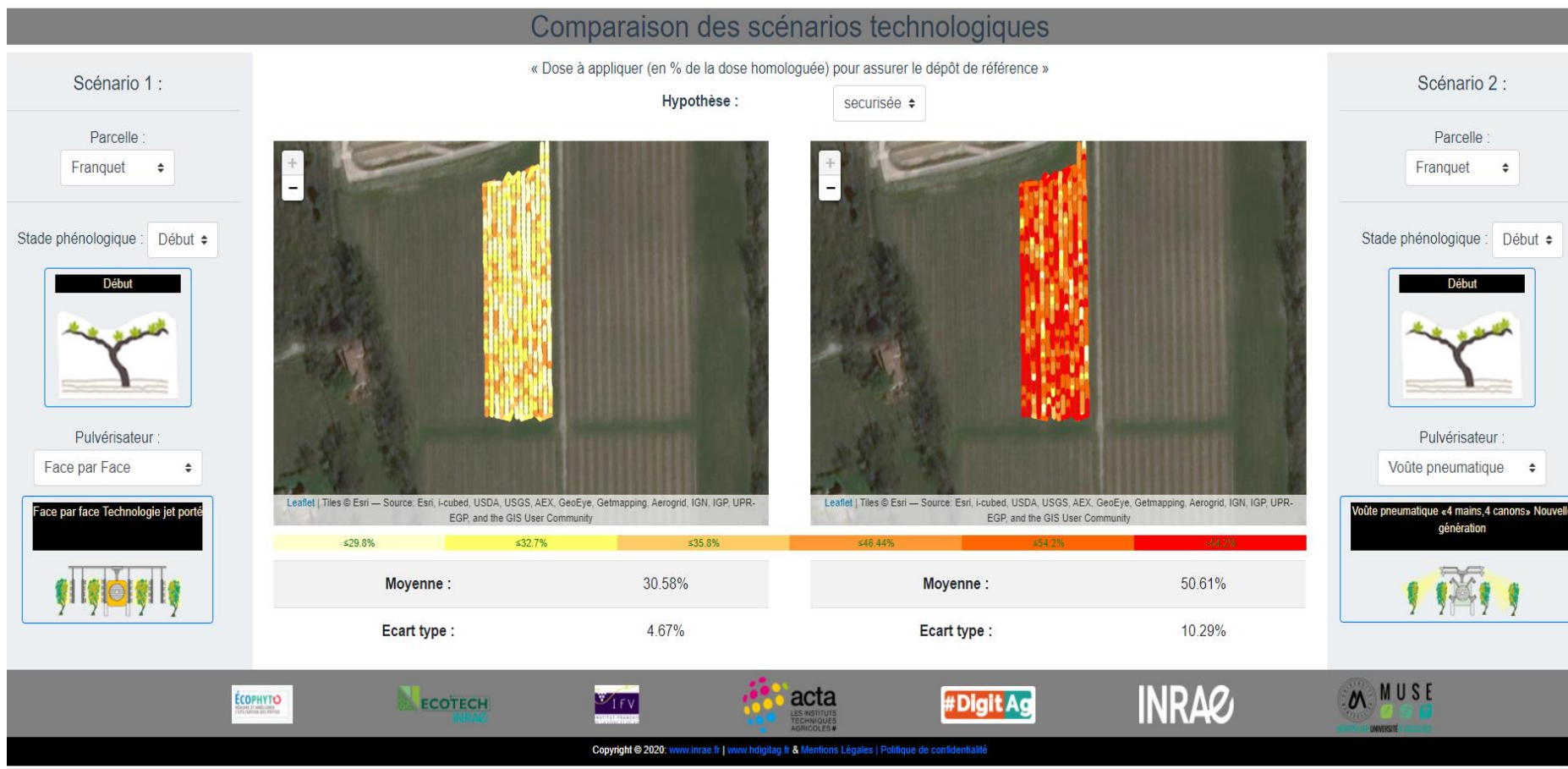
Figure A. 2. Comparaison des doses de produits phytosanitaires à appliquer en fonction des caractéristiques de la végétation et de la performance d'application du pulvérisateur. Exemples de cartes de préconisation obtenues pour deux scénarios technologiques évalués en termes de pourcentage de doses homologuées à appliquer selon l'hypothèse de niveau de protection phytosanitaire « sécurisée ». Scénario 1 (à gauche) : parcelle Franquet, en début de végétation, pulvérisateur face par face. Scénario 2 (à droite) : parcelle Franquet, en début de végétation, pulvérisateur voûte pneumatique. Chaque point représente une unité spatiale (pixel 3 m).
