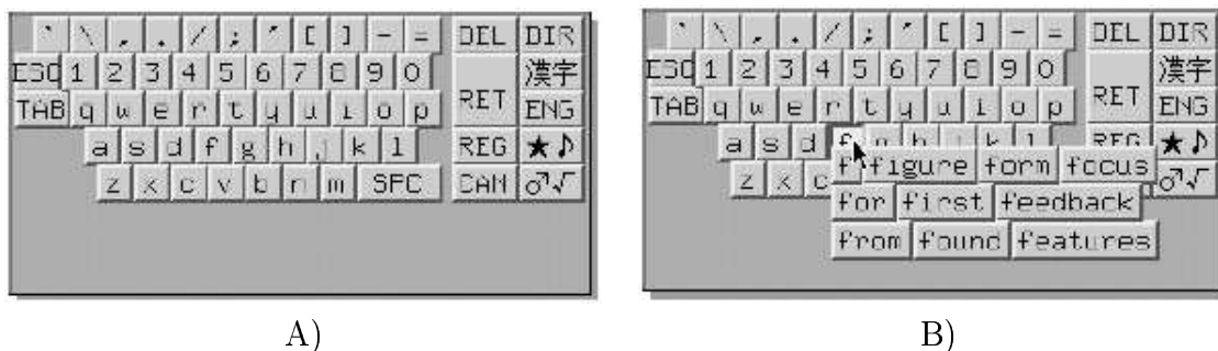
FIG. 31 – Exemple de clavier augmenté par une liste de mots prédits : le clavier POBox [Masui 98]
