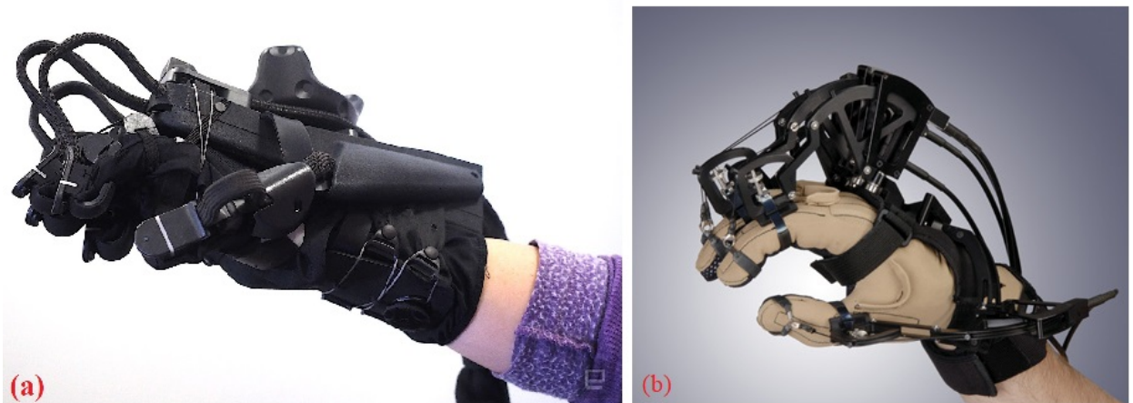
FIGURE 1.3 – Gants à retour haptique : (a) Haptx [14], (b) Cybergrasp [15]
