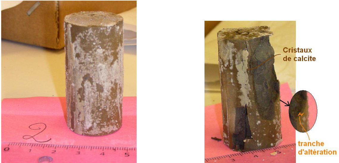
FIGURE 3.9 – Éprouvettes de compression en ciment vieilles en CO_2 aqueux.
