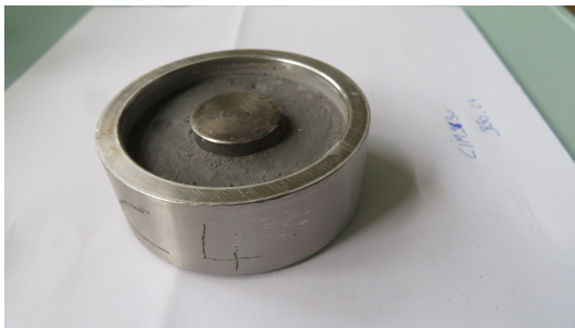
FIGURE 3.18 – Montage de Push-Out ciment/acier du projet européen REXCO 2 (à gauche) et Courbes expérimentales des essais de Push-Out pour une prise du ciment à 100 bars (à droite).[32].
