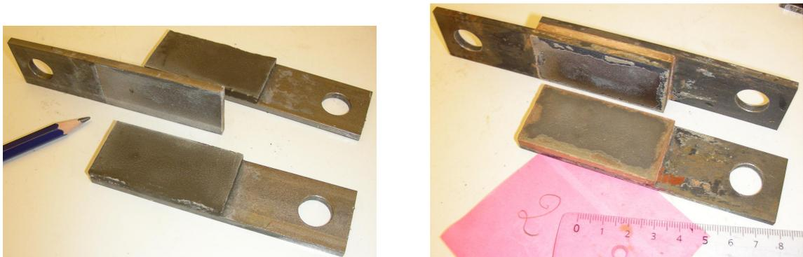
FIGURE 3.8 – Rupture adhésive (sans  $CO_2$ ,  $\tau_{max} = 376 \text{ kPa}$ ) et cohésive (avec  $CO_2$  aqueux,  $\tau_{max} = 628 \text{ kPa}$ ) d'essais de cisaillement sur éprouvettes à double recouvrement.
