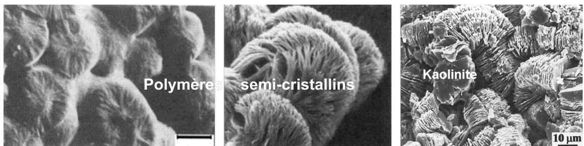
FIGURE 4.1 – Exemple de structures sphérolitiques dans du trans-1, 4-poly isoprene, du PBFP et une kaolinite. D'après [35] et [36]
