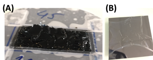
Figure 132 : (A) Photo d'un dispositif bicouches après de le second dépôt d'une dispersion de PEDOT :PSS sur une membrane centrale PEO / PLI C1 (60/40) après polymérisation 3h à 50 °C + 1h à 80 °C, Ar ; (B) Photo d'une membrane centrale PEO / PLI C1 (60/40) dans l'eau après polymérisation 3h à 50 °C + 1h à 80 °C, Ar
