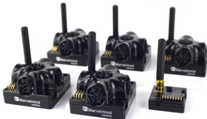
FIGURE 4.8 – Système MarvelMind : Balises et modem
