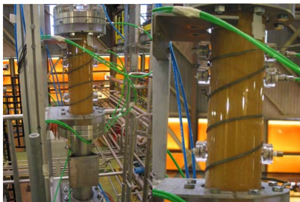
Figure 28: Maquette du lit fixe liquide-solide étudiée pour l'AT du procédé de séparation BTX de l'IFP.
