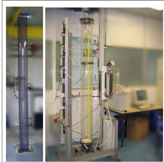
Figure 41: Veines d'essais du LGC pour l'étude des écoulements gaz-particules dense verticaux descendant (gauche) et des mécanismes de défluidisation (droite). Tavares 44 .
