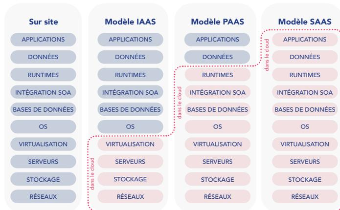
FIGURE 1.1 – Les différents modèles du cloud computing
