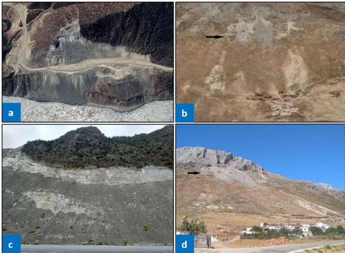
Figure 32 : Exemples d'instabilités de terrain à travers les images satellitaires et sur le terrain. a) Image satellitaire du glissement PK 158. b) image satellitaire de l'éboulement de Jbel Bouzaitoune. c) Photographie du terrain du glissement PK 158. d) Photographie du terrain de l'éboulement de Jbel Bouzaitoune
