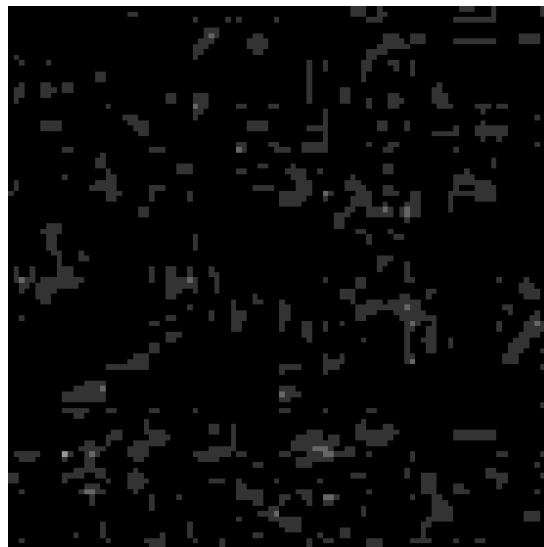
Figure 2.5: Illustration du courant de fuite pour le Sony A7III équipé de son cache avec un temps d'exposition de 30 secondes et une sensibilité ISO à 800.
