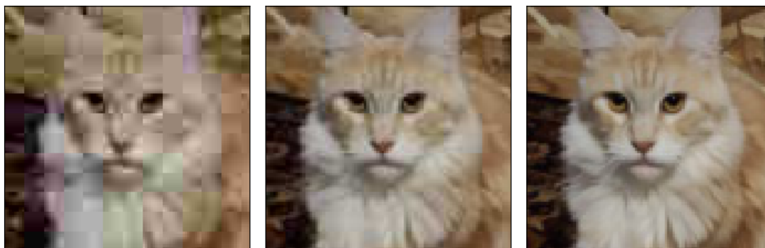
Figure 2.12: Illustration de la quantification d'une image couleur avec un taux de compression en baisse et donc une qualité en hausse, de gauche à droite avec QF \in \{5, 10, 25, 50, 100\} .
