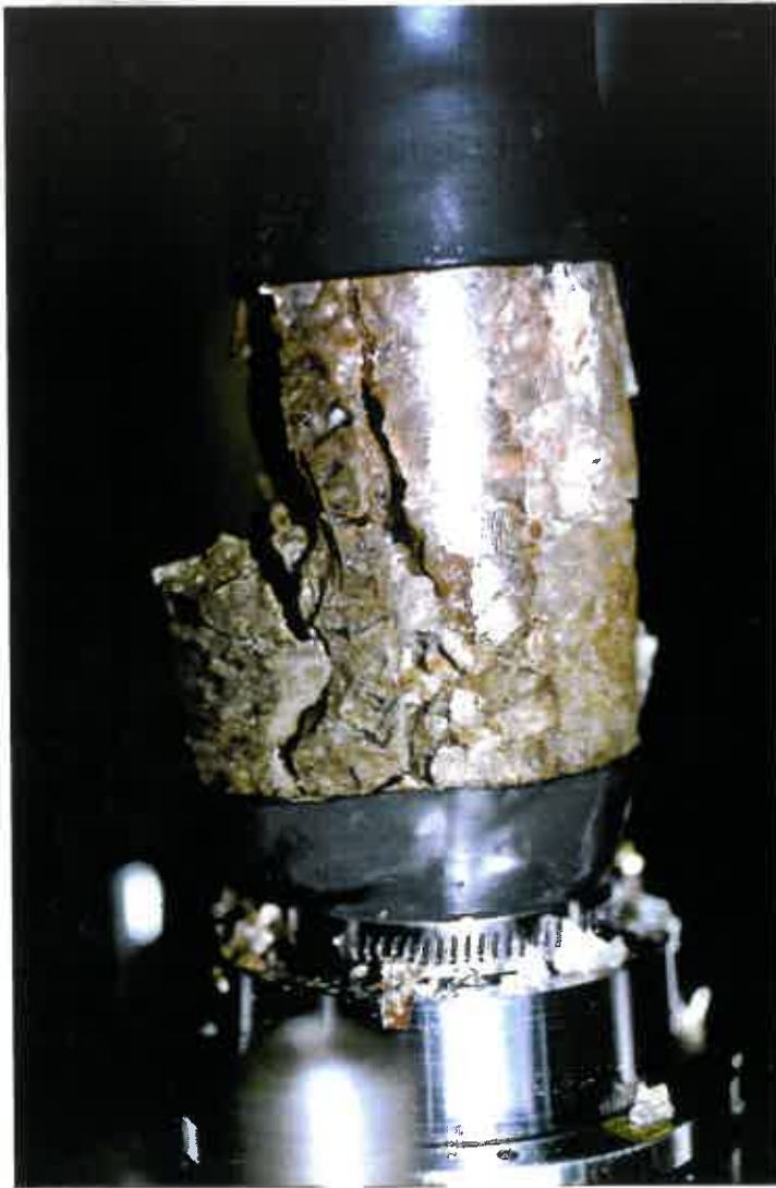
Figure 6. Faciès de fissuration des échantillons non gainés (sous pression directe d'un fluide). On note les colonnettes caractéristiques d'un mode de rupture en l'absence de confinement.
