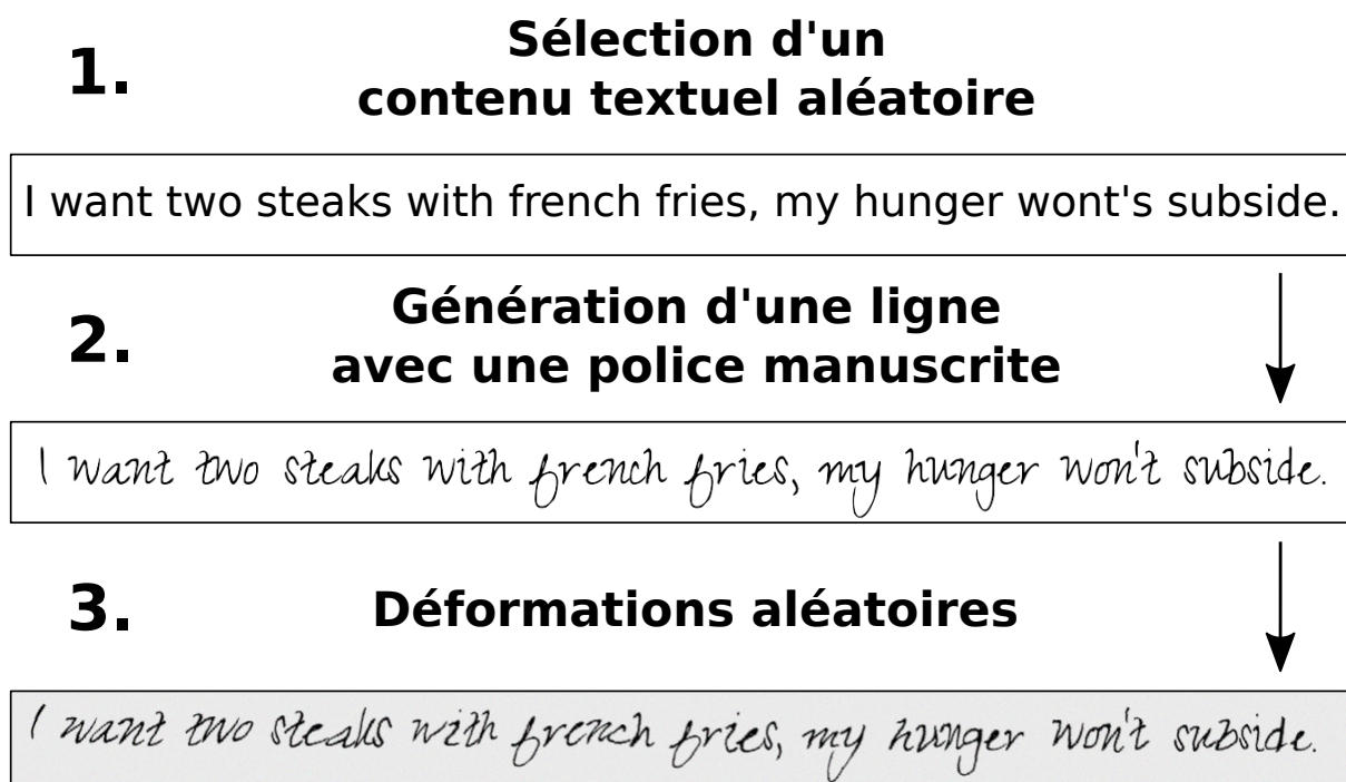
FIGURE 8.1 – Illustration du processus de génération de lignes synthétiques modernes en trois étapes.
