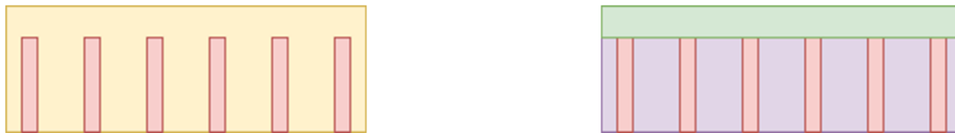
Figure 101 : (a) Schéma d'un NG avec le même polymère (jaune) pour la matrice et la couche capacitive ; (b) Schéma d'un NG avec deux polymères différents pour la matrice (violet) et la couche capacitive (vert)
