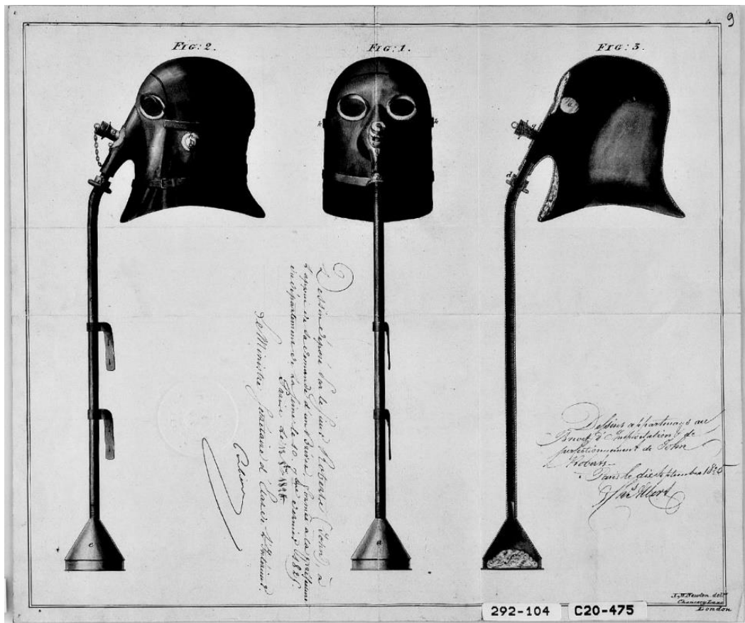
Illustration 97. John Roberts, « appareil conservateur de la respiration », 1825, INPI 1BA2263.
