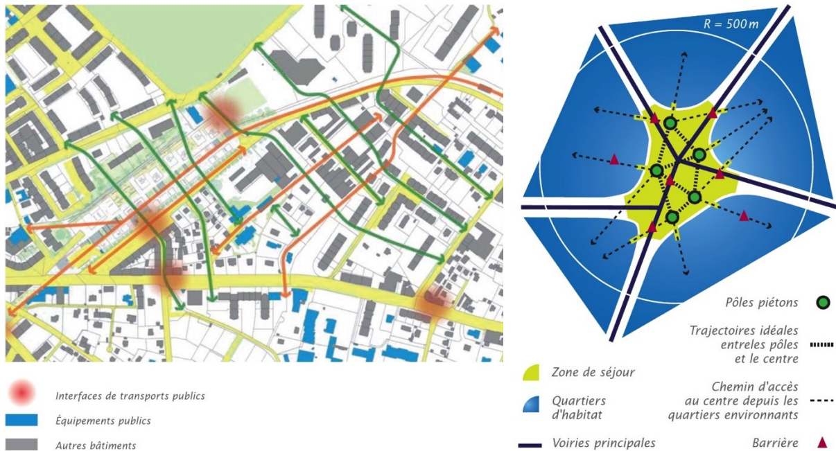
Figure 123. Le Plan Piéton de Genève vise à développer un maillage fin pour les piétons, avec une attention particulière accordée aux accès vers les stations de transport en commun. L'objectif à long terme est de généraliser la maille de 100, voire de 50 mètres de largeur. Aussi, dans le cadre des projets urbains, c'est d'abord le réseau pour les piétons qui est élaboré, et c'est seulement après que ce qui l'entoure peut être construit (source : RBC 2014).
