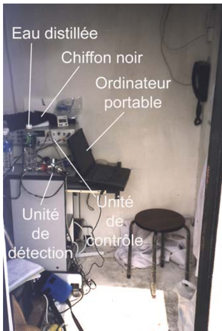
Fig. 18 : Dispositif sur site de la première génération du prototype du fluorimètre ENS. L'unité de détection est reliée à une unité de contrôle (cette unité n'existe plus dans la version suivante du prototype présentée ici) , elle même reliée à un ordinateur portable via une carte d'acquisition. Les algues sont adaptées à l'obscurité dans des cuvettes spectrophotométriques placées sous un chiffon noir. L'eau distillée est indispensable afin de réaliser les mesures de référence.
