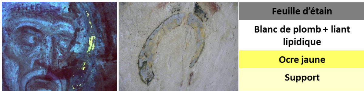
Fig. 10 : Exemple d'une fluorescence jaune observée sur les peintures murales de l'ancien logis abbatial de Moissac, caractéristique de l'emploi d'un liant lipidique, sous UV (~50 cm 2 ). L'échantillonnage dans des zones spécifiques des peintures ont permis de mettre en évidence la présence d'anciens décors métalliques, ici à la feuille d'étain collée sur une couche de mixtion (huile + blanc de plomb).
