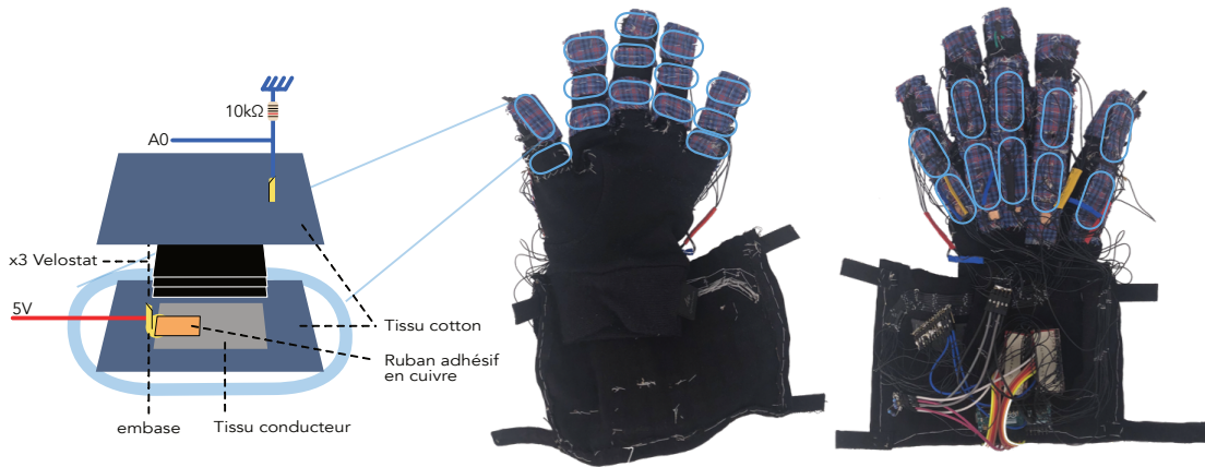
FIGURE 6.3: Vue éclatée d'un capteur et de la position des capteurs sur notre gant DIY . Les capteurs situés sur le devant de la main sont utilisés pour détecter la pression de la phalange. Les capteurs situés sur le dos de la main servent à détecter la flexion des doigts. Pour chaque capteur, deux électrodes en tissu conducteur sont cousues sur un tissu en coton. Une cosse électrique est cousue sur le tissu conducteur pour souder les fils de l'Arduino. Le ruban de cuivre augmente la conductivité entre le tissu conducteur et l'anneau de connexion. Entre les électrodes, il y a 3 couches de la marque Velostat™. Une électrode est connectée à la broche 5V de l'Arduino, l'autre à un diviseur de tension. Le diviseur de tension est ensuite connecté à une entrée analogique de l'Arduino (par exemple la broche A0).
