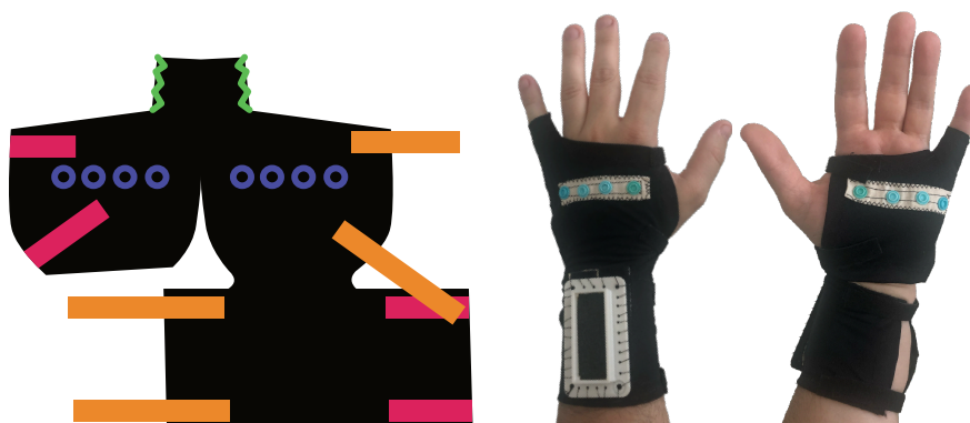
FIGURE 8.2: À gauche, Patron de la mitaine pour le gant en kit. Les rectangles de couleur représentent les bandes de velcro™(crochet, boucle). Les zigzags verts montrent la couture à effectuer pour coudre la mitaine. Les ronds bleus représentent les boutons pressions. À droite, photo de la mitaine du gant en kit.
