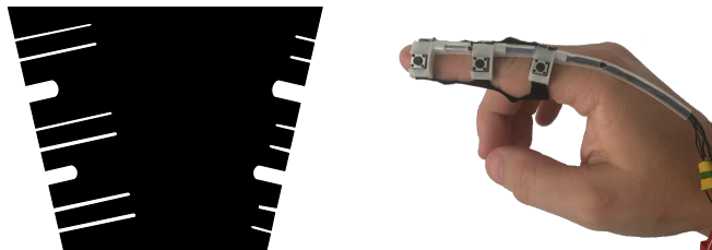
FIGURE 8.4:   gauche, patron de d coupe du manchon.   droite, photo du manchon avec boutons-poussoirs. Manchon co-fabriqu  avec Michael Ortega.
