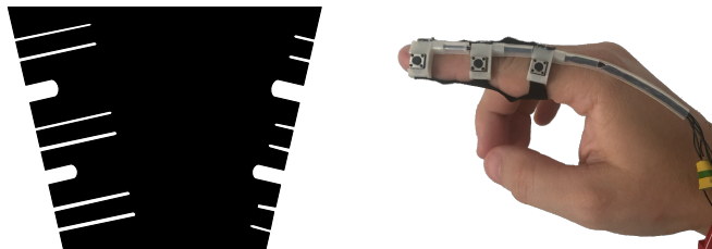
FIGURE 8.4: À gauche, patron de découpe du manchon. À droite, photo du manchon avec boutons-poussoirs. Manchon co-fabriqué avec Michael Ortega.
