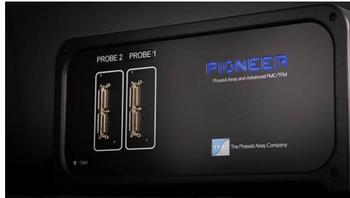
Figure 4.3 : Système d'acquisition Pioneer AWG de la société TPAC.
