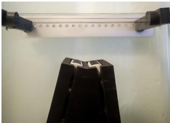
Figure 5.13 : Photographie du moule imprimé en 3-D, des 2 sondes ALS L12-5 ainsi que du milieu imagé composé de 5 fils de nylon. La position des sondes est ajustée pour que le fil central soit à équidistance des 2 sondes.
